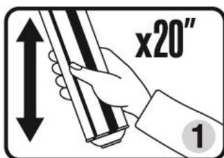
1. Las superficies han de estar limpias de polvo, grasa, aceite y otras impurezas. Las superficies secas y porosas han de ser humedecidas con agua. La temperatura óptima de trabajo del bote es entre 20°C y 25°C. Si la temperatura es más baja, colocar el bote en agua caliente (max. T=40°C) unos 20 minutos. Agitar el bote exhaustivamente (20 veces aproximadamente) con la válvula hacia abajo antes de usar y colocar el bote en la pistola de aplicación.
