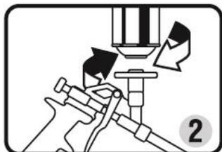
2. Den Abzug betätigen, damit der Schaum hinausströmen kann (ca. 2 Sekunden). Auf diese Weise wird das Verlängerungsrohr mit Schaum gefüllt. Die Pistole ist nun gebrauchsfertig. Während des Auftragens des Schaums die Pistole mit dem Behälter in einer aufrechten Position halten. Der Schaumaustritt kann über den Abzug eingestellt und mit Hilfe der Einstellschraube auf der Rückseite der Pistole kontrolliert werden..
