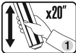
1. Die Oberflächen müssen frei von Staub, Fett, Öl und anderen Verunreinigungen sein. Trockene und poröse Oberflächen müssen mit Wasser befeuchtet werden. Die optimale Verarbeitungstemperatur des Behälters liegt zwischen 20 °C und 25 °C. Wenn die Temperatur niedriger ist, den Behälter ca. 20 Minuten lang in warmes Wasser stellen (max. T=40 °C). Vor dem Gebrauch den Behälter mit nach unten ausgerichtetem Ventil gründlich schütteln (ca. 20 Mal).
