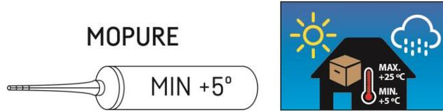
Haltbarkeit bei ungeöffneter Kartusche: 24 Monate nach Fertigung. Das Verfalldatum ist außen an der Kartusche angegeben.
