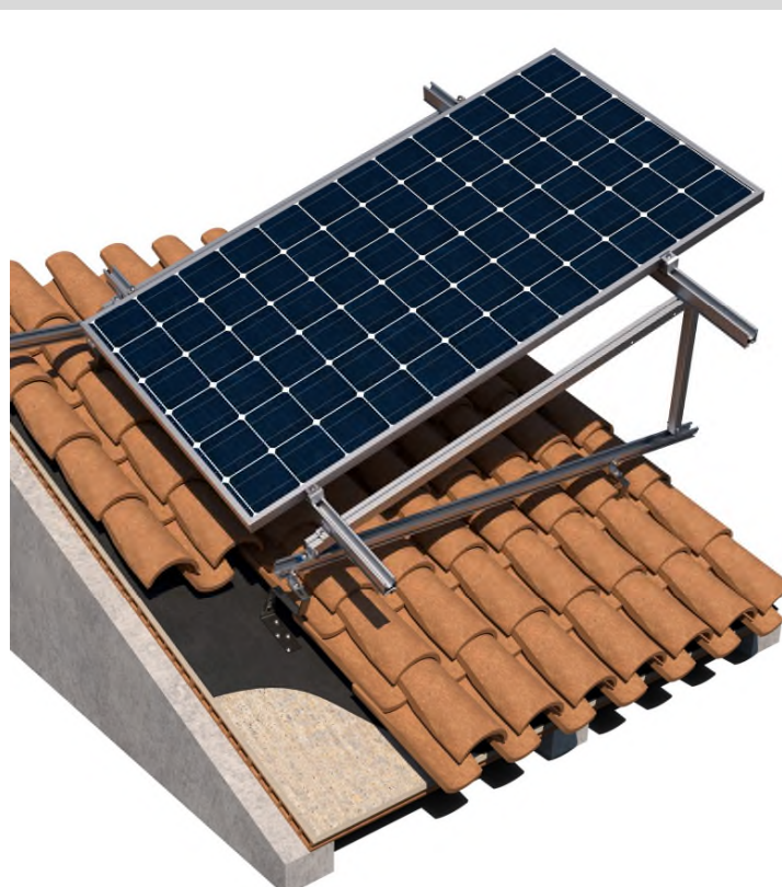
Exemplo 2: Cobertura de telha curva com subestrutura de madeira / fixação com parafuso de rosca dupla KFS-MA
