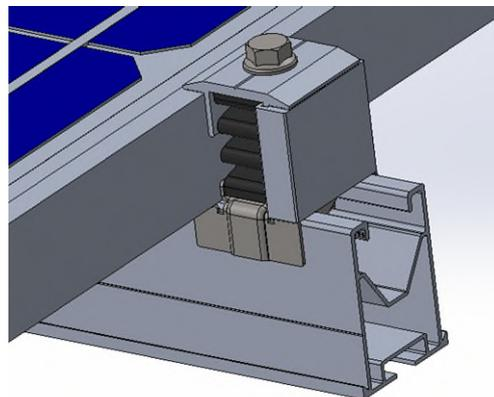
La medida de galgas elegidas debe ser igual a la altura de marco de las placas solares a instalar.
