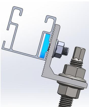
**!** Para asegurarse de que la cabeza del conector KFS-FI queda orientada en sentido perpendicular al perfil existe una muesca en la base del tornillo. Esta muesca indica la posición final de la cabeza, por lo que es necesario que **cuando acabe la instalación se encuentre perpendicular al perfil. Nunca debe quedar la muesca paralela al perfil o inclinada una vez apretado.**
