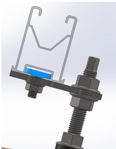
**!** Pour s'assurer que la tête du connecteur KFS-FI est orientée perpendiculairement au profilé, il existe une encoche sur la base de la vis qui indique la position finale de la tête. **Cette encoche doit donc être perpendiculaire au profilé à la fin de l'installation et ne doit jamais être parallèle au profilé ou inclinée une fois serrée.**
