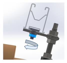
**F.** Um das Profil PSE-A endgültig zu befestigen, überprüfen Sie, ob der Kopf des Verbinders KFS-FI richtig ausgerichtet ist und ziehen Sie ihn mit einem Sechskantschlüssel (SW-13) mit einem maximalen Drehmoment von 15 Nm fest.
