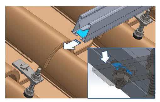
**C.** Heben Sie den Verbinder KFS-FI leicht an und drehen Sie seinen Kopf in die Rille, bis er einrastet, während Sie die untere Mutter des Verbinders von Hand anziehen.
