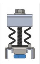
1. Setzen Sie die Klemme so in die Führung, dass der untere Kopf parallel zur Führung liegt.
