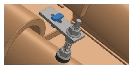
**B.** Setzen Sie das Profil PSE-A auf die Befestigung, indem Sie den Kopf des Verbinders KFS-FI in die Rille des Profils PSE-A einführen.
