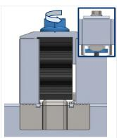
4. Um die eingefügten Elemente zu fixieren, müssen Sie die Schraube drehen, bis sie mit dem Profil in Kontakt kommt. Achten Sie darauf, dass der untere Kopf senkrecht zur Führung bleibt.
