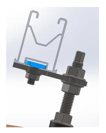
Um sicherzustellen, dass der Kopf des Verbinders KFS-FI senkrecht zum Profil ausgerichtet ist, befindet sich an der Basis der Schraube eine Kerbe. Diese Kerbe zeigt die endgültige Position des Kopfes an, so dass er bei Abschluss des Einbaus senkrecht zum Profil stehen muss. Die Kerbe darf nach dem Anziehen niemals parallel zum Profil bzw. schräg sein.
