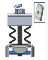
2. Um die Klemme an der Führung zu befestigen, müssen Sie den unteren Kopf mit Hilfe der Schraube in die Position senkrecht zur Führung drehen, den Schraubenkopf drücken und drehen. Die Mutter hat eine Zahnschiene, um die Befestigung zu sichern.
