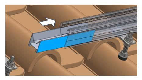
**B.** Befestigen Sie den Verbinder PSE-UN an dem ersten Profil PSE-A, indem Sie 2 Bohrschrauben ABEI5519 aus rostfreiem Stahl anbringen. Die Schrauben müssen in den Rillen an den Seiten des Profils angebracht werden, um das Bohren zu erleichtern, und zwar in einem Abstand von 50 bis 70 mm vom Ende des Profils. Für den Einbau der Schrauben ABEI5519 benötigen Sie einen elektrischen Schraubendreher mit Innensechskant SW-8. Es wird eine Einbaugeschwindigkeit von 1800 U/min empfohlen.
