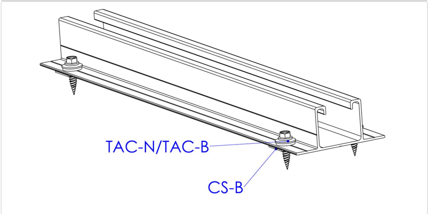
Befestigung mit Dünnblech-Bohrschraube Atlantis/Bimetal (TAC-N/TAC-B)
