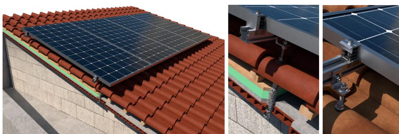
Esempio 2: tetto in tegole curve con sottostruttura in muratura / fissaggio con gancio salva tegole GS-TC
