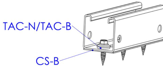
Befestigung mit Dünublech-Bohrschraube Atlantis/Bimetal (TAC-N/TAC-B)
