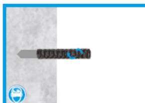
Introduire l'armature exempte d'huiles ou d'autres résidus jusqu'au fond du trou en appliquant un mouvement rotatif alternatif jusqu'à ce que tous les pas du filetage soient totalement enrobés. Ajustez-la jusqu'à sa position correcte sans excéder le temps de manipulation permis.
