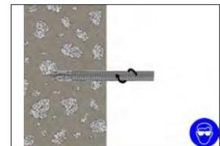
8. Überschüssiger Mörtel tritt gleichmäßig aus dem Bohrloch um die Verankerung herum aus und zeigt an, dass das Bohrloch voll ist.
