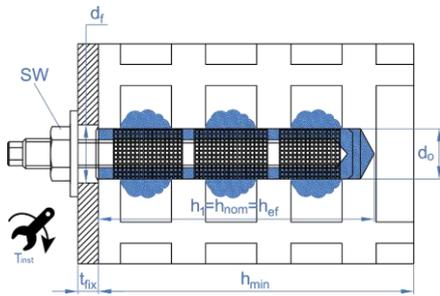
Für Verankerungen in Hohlsteinen ist ein Sieb aus Kunststoff oder Metall zu verwenden, um zu vermeiden, dass das Harz durch die Hohlräume fällt.
